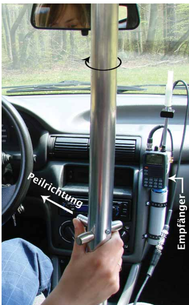
Abb. 3.2: Drehbares Alurohr in der Mitte des Telemetriefahrzeugs mit einer Koaxialkabel-Verbindung zwischen der Richtantenne über dem Autodach und dem Empfänger im Innenraum; Foto: Nora Künkler, verändert
