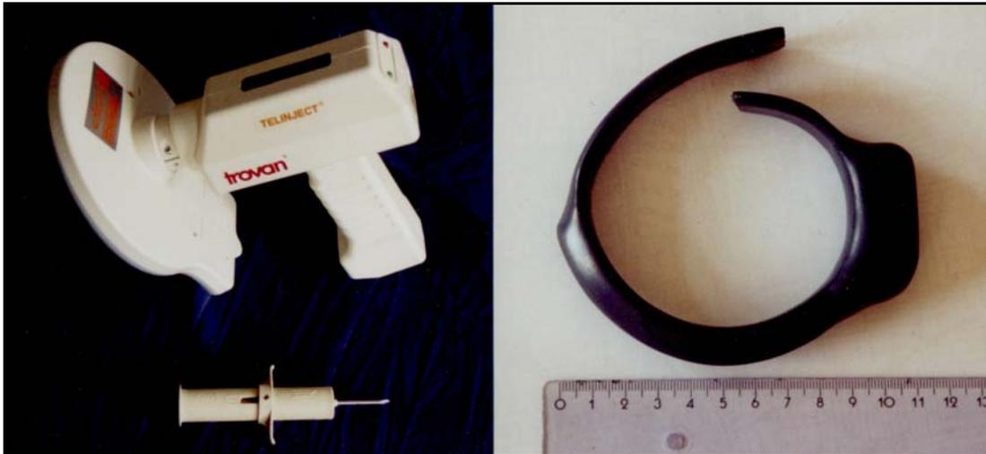
**Abb. 10:** Verwendetes Transponder-Lesegerät und Injektor (links), UKW-Waschbärsender mit Batterie/Sendereinheit und innenliegender Antenne. (Fotos F. Michler)
