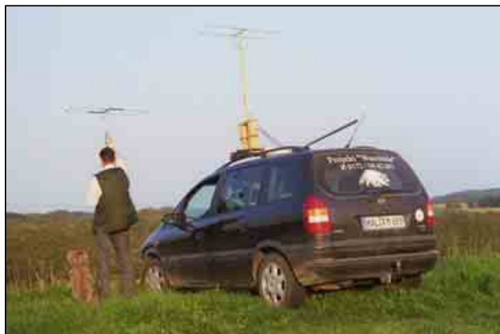
Abb. I PKW mit montierter Dachantenne. Durch das Bowdenzugsystem lässt sich die Antenne vom Inneren des Autos in alle Richtungen drehen, Müritz-Nationalpark Juli 2006 (Foto: Berit Köhneemann).
