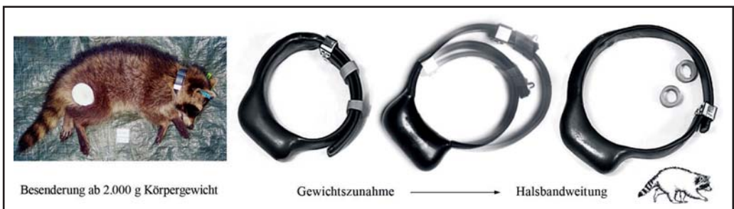
Abb. 1 Schematische Funktionsweise eines expandierenden Halsbandsenders für juvenile Waschbären Fotos: Frank Michler, Roman Vitt; Grafik: Irina Muschik
